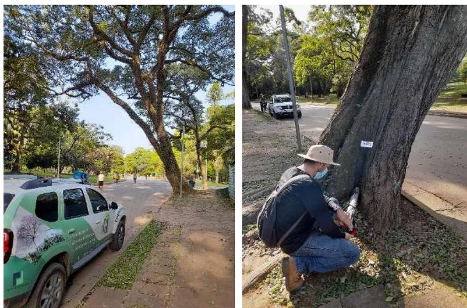
Figura 36: Análise de penetrografia realizada no Ibirapuera.
