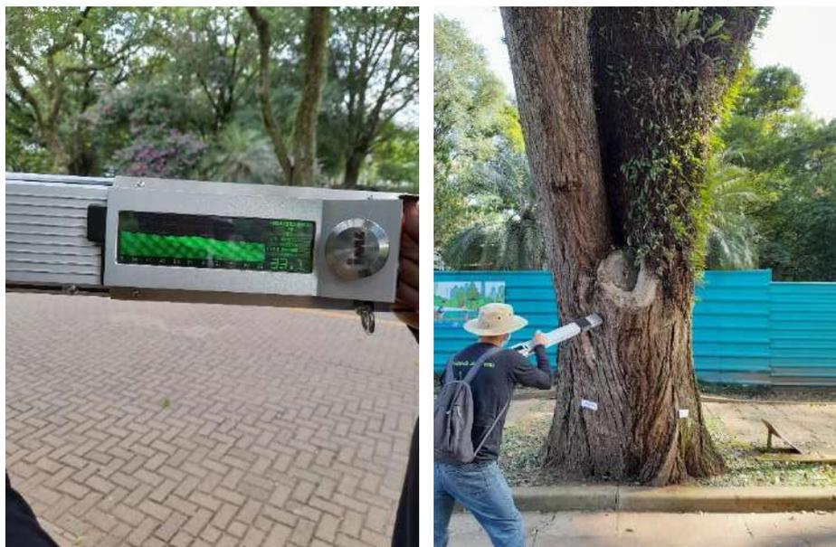
Figura 37: Análise de penetrografia realizada no Ibirapuera.
